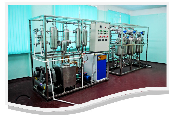
Ферментер – оборудование для производства микробиологических удобрений
